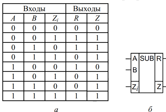
Рис.8. Таблица истинности (а) и условное обозначение (б) одноразрядного вычитателя
